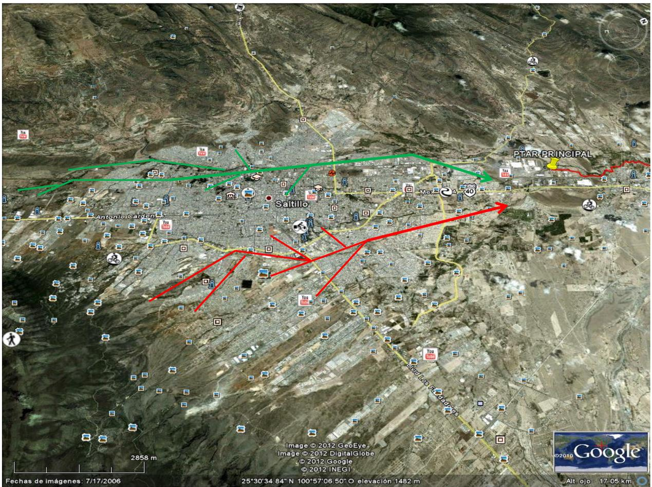
Figura 1. Plano de la ciudad que muestra el sistema de recolección de aguas residuales del área urbana de Saltillo. En rojo se muestra al recolección de las AR del oriente y en verde la recolección de las AR del poniente.
